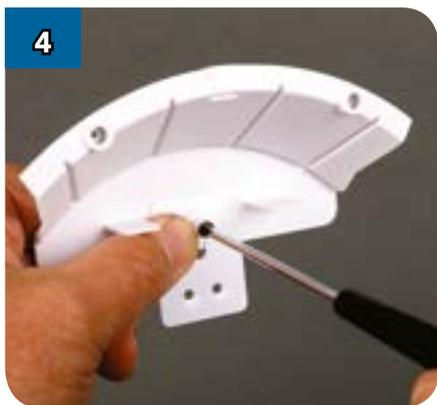
4 Закрепите втулку фланцевым саморезом 2 x 4 мм. Не перетяните саморез: пластина должна свободно двигаться.
