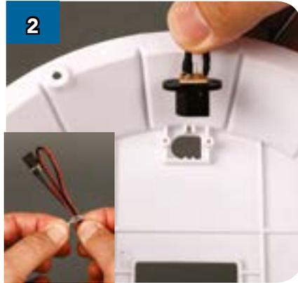
Расправьте провод разъёма и установите разъём на своё место, руководствуясь фотографией.
