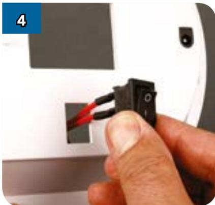
Расправьте провод главного выключателя и пропустите его снаружи в отверстие нижней панели.
